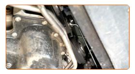
5 Entfernen Sie den Keilrippenriemen.
