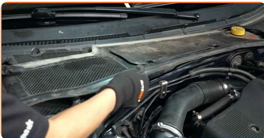
**6** Drücken Sie auf die Halteclips des Pollenfilters, um sie zu lösen.
