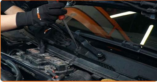
**14** Bauen Sie das Windabweiserabdeckung ein und sichern Sie diese. Verwenden Sie den Torx T20. Verwenden Sie einen flachen Schraubendreher.
