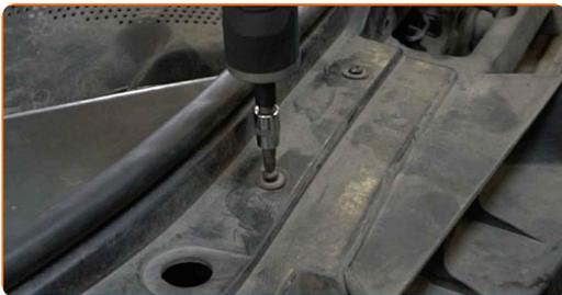
**4** Entferne die Komponenten des Lüftungskanals.
