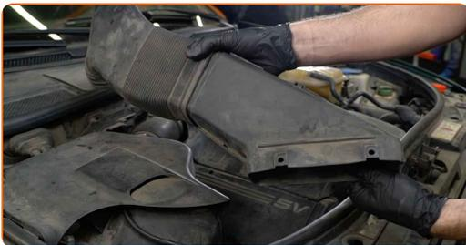
**5** Schrauben Sie das Verbindungsstück der Motorhaube ab. Verwenden Sie einen flachen Schraubendreher.
