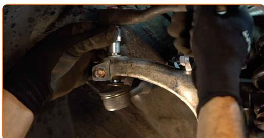
**21** Beim Deinstallieren sollten Sie die genaue Position des Kugelgelenks an der Spurstange markieren oder messen - oder zählen Sie die Anzahl der Windungen, um danach eine Fehlausrichtung zu vermeiden. Verwenden Sie einen Messschieber.
