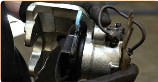
**26** Installieren Sie den Bremssattel und fixieren Sie diesen. Verwenden Sie Inbusschlüssel Nr. H7. Verwenden Sie einen Drehmomentschlüssel. Ziehen Sie ihn mit 30 Nm Drehmoment fest.
