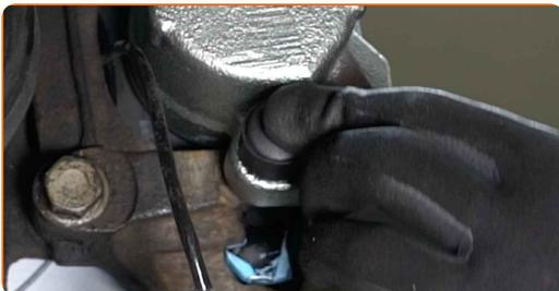
**28** Bauen Sie die Halteklammer des Bremsbelags ein. Benutzen Sie ein Brecheisen.
