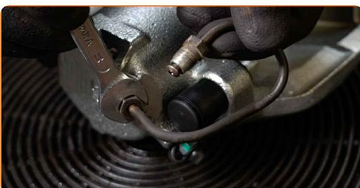
**24** Schrauben Sie die Befestigungen der Bremschlauchhalterung ein. Verwenden Sie Ring-Gabelschlüssel Nr. 10.
