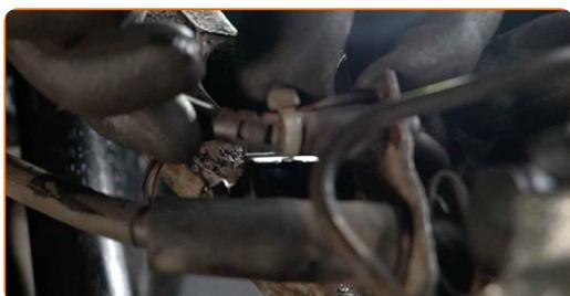
**33** Verbinden Sie den Stecker des Verschleißsensors der Bremsbeläge.
