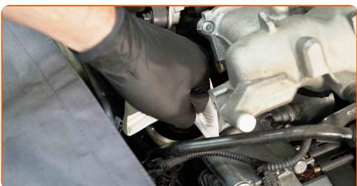
**14** Schmieren Sie die Gummidichtung des neuen Filters mit einer kleinen Menge frischen Öls.
