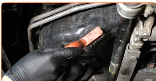
**8** Drehen Sie die Ablassschraube heraus. Verwenden Sie den Torx T45. Verwenden Sie einen Ratschenschlüssel.
