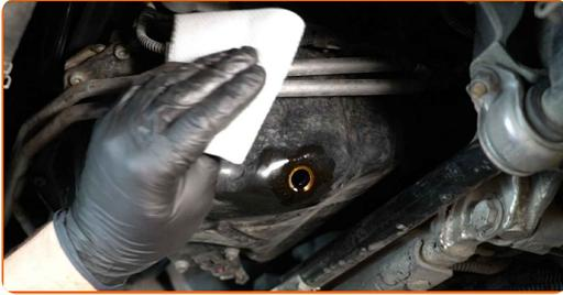
**19** Schrauben Sie die neue Ablassschraube ein und ziehen Sie sie fest. Verwenden Sie den Torx T45. Verwenden Sie einen Drehmomentschlüssel. Ziehen Sie ihn mit 26 Nm Drehmoment fest.
