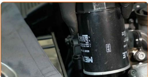
**Austausch: Motoröl und Ölfilter – AUDI A6 C7 Limousine (4G2, 4GC). Tipp:**
