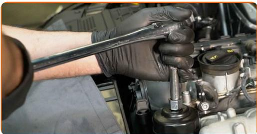
**12** Entfernen Sie den Ölfilter. Legen Sie den alten Ölfilter in den Behälter.
