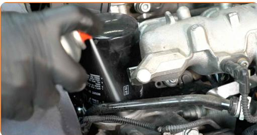
**11** Schrauben Sie den Ölfilter ab. Verwenden Sie Steckschlüssel 76-14F. Verwenden Sie einen Ratschenschlüssel.
