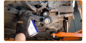
Drehen Sie das Befestigungselement auf, das die Koppelstange mit dem Querlenker verbindet. Verwenden Sie Stecknuss Nr. 15.
