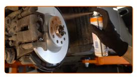
Die Bremsscheibenoberfläche reinigen. Benutzen Sie einen Bremsenreiniger.
