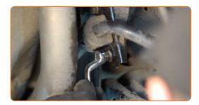
Drehen Sie die Befestigungen heraus, die die Druckstange mit dem Stabilisator verbinden. Verwenden Sie Ring-Gabelschlüssel Nr. 15. Verwenden Sie Stecknuss Nr. 15. Verwenden Sie einen Ratschenschlüssel.
