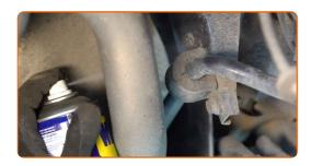
Schrauben Sie die Befestigungen der Stabilisatorbuchsenhalter heraus. Verwenden Sie Ring-Gabelschlüssel Nr. 15. Verwenden Sie Stecknuss Nr. 15.
