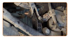
Schrauben Sie die Befestigungen der Stabilisatorbuchsenhalter ein. Verwenden Sie Ring-Gabelschlüssel Nr. 15. Verwenden Sie Stecknuss Nr. 15. Verwenden Sie einen Drehmomentschlüssel. Ziehen Sie ihn mit 35 Nm Drehmoment fest.
