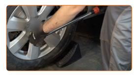
Entfernen Sie den Wagenheber sowie die Unterlegkeile.
