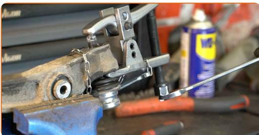
**21** Verbinden Sie das Kugelgelenk mit dem Lenker.
