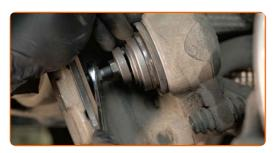
Behandeln Sie die Bremsbeläge in dem Bereich, wo ihre Oberfläche mit dem Bremssattelhalter in Berührung tritt. Benutzen Sie eine Anti-Quietsch-Paste.
