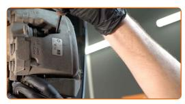
Lösen Sie die Bremssattel-Haltefeder. Benutzen Sie ein Brecheisen. Verwenden Sie einen flachen Schraubendreher.
