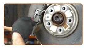
Entfernen Sie den Bremssattel.
