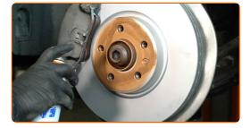
Die Bremsscheibenoberfläche reinigen. Benutzen Sie einen Bremsenreiniger.
