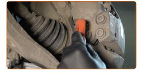
Schrauben Sie die Befestigung des Bremssattels ab. Verwenden Sie Stecknuss Nr. 13. Verwenden Sie einen Ratschenschlüssel.
