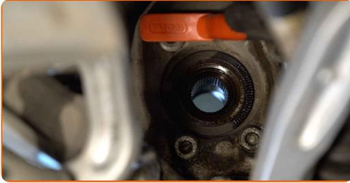
**29** Schrauben Sie die Nabenlagerhalterung ab. Benutzen Sie den XZN #12. Verwenden Sie einen Ratschenschlüssel. Verwenden Sie ein Windeisen.
