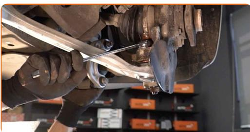
**18** Entfernen Sie die Befestigungsschraube.
