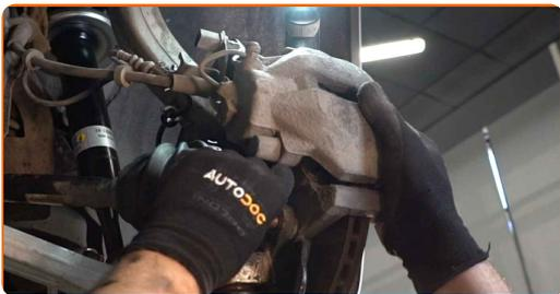
**57** Befestigen Sie die Bremssattelhalterung. Verwenden Sie Stecknuss Nr. 21. Verwenden Sie einen Drehmomentschlüssel. Ziehen Sie ihn mit 190 Nm Drehmoment fest.
