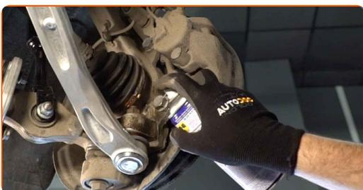
**11** Lösen Sie die Befestigung der Sattelhalterung. Verwenden Sie Stecknuss Nr. 21. Verwenden Sie einen Ratschenschlüssel. Verwenden Sie ein Windeisen.
