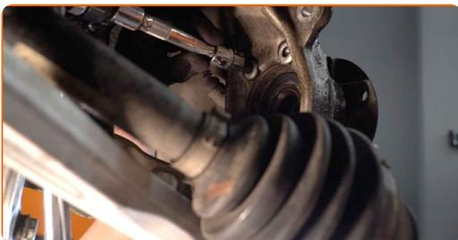
**30** Entfernen Sie die Radnabe zusammen mit dem Lager. Verwenden Sie den Schlaghammer-Nabenabzieher.
