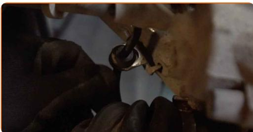
**59** Verbinden Sie den Bremsbelag-Verschleiß-Sensor.
