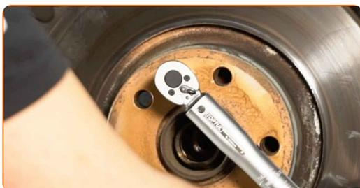
**56** Setzen Sie die Halterung des Bremssattels ein.
