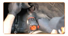
Entfernen Sie die Befestigungsschraube.
