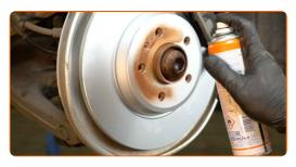
Die Bremsscheibenoberfläche reinigen. Benutzen Sie einen Bremsenreiniger.
