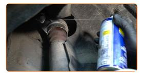
Schrauben Sie den unteren Befestiger des Stoßdämpfers ab. Verwenden Sie Stecknuss Nr. 21. Verwenden Sie einen Ratschenschlüssel.
