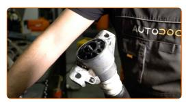
Schrauben Sie die untere Befestigung der Federbeinkolbenstange an. Verwenden Sie einen Stoßdämpfer Steckschlüsseleinsatz DDNº6. Verwenden Sie Stecknuss Nr. 16. Verwenden Sie einen Drehmomentschlüssel. Ziehen Sie ihn mit 35 Nm Drehmoment fest.
