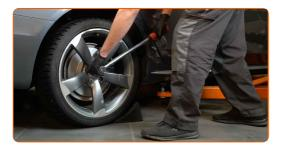
Entfernen Sie den Wagenheber sowie die Unterlegkeile.
