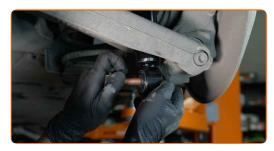
Schrauben Sie das untere Befestigungselement des Stoßdämpfers ein. Verwenden Sie Stecknuss Nr. 21. Verwenden Sie einen Ratschenschlüssel.
