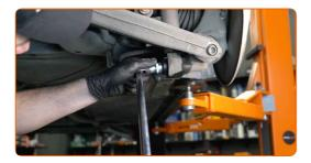
11 Entfernen Sie die Befestigungsschraube.
