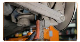
Schrauben Sie die Befestigungselemente der Radkastenabdeckung heraus und entfernen Sie sie. Verwenden Sie einen Lösehebel, um die Clips zu entfernen.
