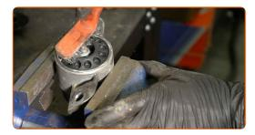
Entfernen Sie die Befestigung der Stoßdämpferkolbenstange. Verwenden Sie einen Stoßdämpfer Steckschlüsseleinsatz DDNº6. Verwenden Sie Stecknuss Nr. 16. Verwenden Sie einen Ratschenschlüssel.
