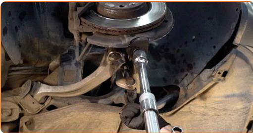
**71** Ziehen Sie die oberen Befestigungsschrauben an (2 Stück). Verwenden Sie Ring-Gabelschlüssel Nr. 18. Verwenden Sie Stecknuss Nr. 18. Verwenden Sie einen Drehmomentschlüssel. Ziehen Sie ihn mit 45 Nm Drehmoment fest.
