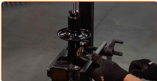
**44** Installieren Sie die Feder am Stoßdämpfer.
