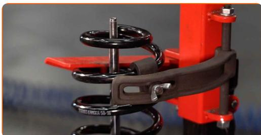
**46** Bringen Sie das Stützlager, die Manschette und den Anschlagpuffer auf dem Stoßdämpfer an.
