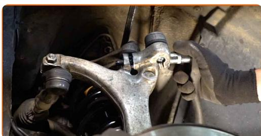
**68** Montieren Sie den Querlenker.
