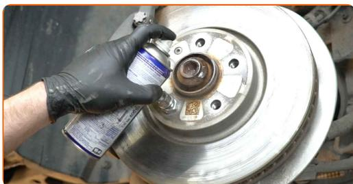
**23** Schrauben Sie die Radnaben-Achsmutter ab. Verwenden Sie Inbusschlüssel Nr. H18. Verwenden Sie ein Windeisen.
