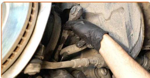
**89** Ziehen Sie die Befestigungselemente des Stabilenkers fest. Verwenden Sie Ring-Gabelschlüssel Nr. 16 (2 Stück).
