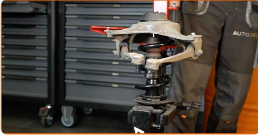
**63** Entfernen Sie das zusammengebaute Federbein.
