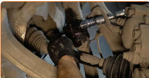
**21** Entfernen Sie die Befestigungsschraube.
