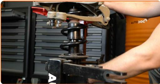
**64** Reinigen Sie die Montagesitze der Stoßdämpfergabel. Benutzen Sie eine Drahtbürste. Benutzen Sie WD-40-Spray.
