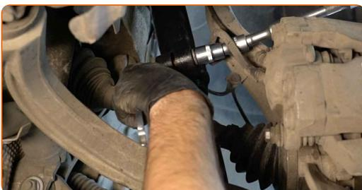
**87** Reinigen Sie die Montagesitze der Koppelstange. Benutzen Sie eine Drahtbürste. Benutzen Sie WD-40-Spray.
