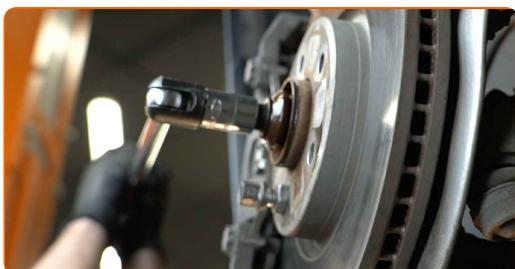
**24** Schrauben Sie die Befestigungsschraube heraus, die die Stoßdämpfergabel mit dem unteren Querlenker verbindet. Verwenden Sie Ring-Gabelschlüssel Nr. 18. Verwenden Sie Stecknuss Nr. 18. Verwenden Sie einen Ratschenschlüssel.
