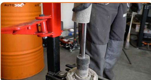
**57** Installieren Sie die Feder am Stoßdämpfer.
