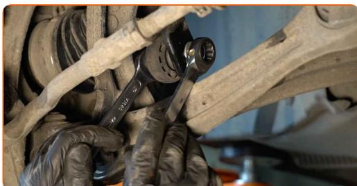
**90** Stützen Sie den Arm. Benutzen Sie einen hydraulischen Getriebeheber.
