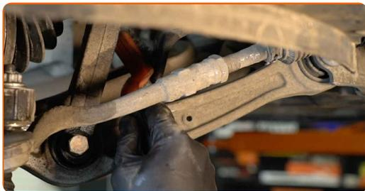
**88** Montieren Sie den Querlenker.
