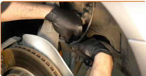
**26** Reinigen Sie den Stecker des ABS-Sensors. Verwenden Sie eine Nylon-Reinigungsbürste. Benutzen Sie WD-40-Spray.
