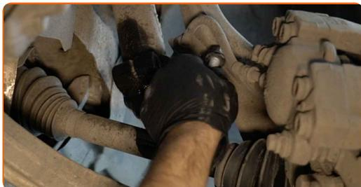
**22** Reinigen Sie das Befestigungselement der Radnabe. Benutzen Sie eine Drahtbürste. Benutzen Sie WD-40-Spray.
