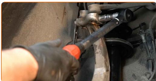
**98** Ziehen Sie die Nabe hindurch. Verwenden Sie Inbusschlüssel Nr. H18. Verwenden Sie einen Drehmomentschlüssel. Ziehen Sie ihn mit 200 Nm Drehmoment fest.
