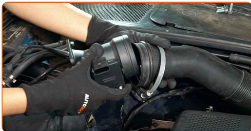
**11** Schrauben Sie die Befestigungen des LMM ein. Verwenden Sie Stecknuss Nr. 10. Verwenden Sie einen Drehmomentschlüssel. Ziehen Sie ihn mit 4 Nm Drehmoment fest.
