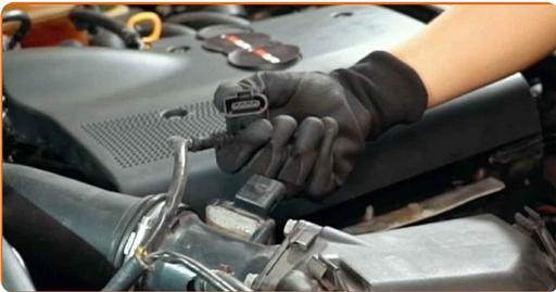
**7** Lockern Sie die Befestigungsklemme, die das Luftkanal-Gehäuse mit dem Luftfilter-Gehäuse verbindet. Verwenden Sie Stecknuss Nr. 7. Verwenden Sie einen Ratschenschlüssel.
