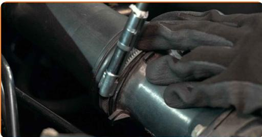
**8** Schrauben Sie die Befestigungen des LMM ab. Verwenden Sie Stecknuss Nr. 10. Verwenden Sie einen Ratschenschlüssel.
