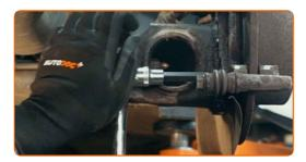
Entfernen Sie die Sattelhalterung.
