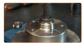
Behandeln Sie das Radnabenlager. Verwenden Sie Mehrzweckfett.
