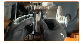
Installieren Sie den Bremssattel und fixieren Sie diesen. Verwenden Sie Ring-Gabelschlüssel Nr. 15. Verwenden Sie Stecknuss Nr. 13. Verwenden Sie einen Drehmomentschlüssel. Ziehen Sie ihn mit 35 Nm Drehmoment fest.
