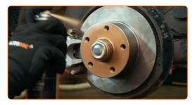
Die Bremsscheibenoberfläche reinigen. Benutzen Sie einen Bremsenreiniger.
