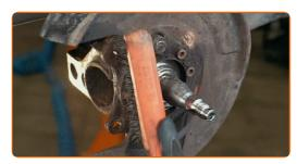
Drücken Sie das Radnabenlager heraus. Verwenden Sie einen Druckstücksatz mit Ein-/Auspresswerkzeug. Benutzen Sie einen Hammer.
