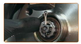
Installieren Sie die Kappe der Nabenmutter. Verwenden Sie einen Gummi-Hammer.
