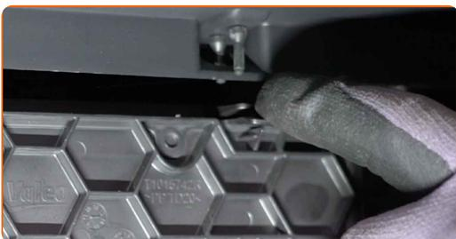
**5** Entfernen Sie den Gehäusedeckel des Innenraumfilters.
