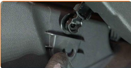
**4** Lösen Sie die Befestigungsclips der Innenraumfilterabdeckung.
