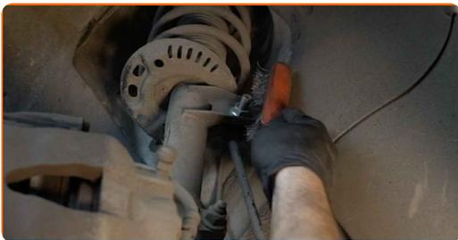
**14** Schrauben Sie das Befestigungselement heraus, das die Druckstange mit dem Federbein verbindet. Verwenden Sie Stecknuss Nr. 18. Verwenden Sie einen Ratschenschlüssel.
