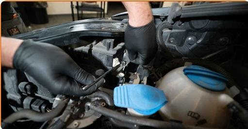
**3** Lösen Sie die Glühlampenhaltung, indem Sie diese etwa um 30° drehen. Entfernen Sie die Halterung aus dem Scheinwerferträger.
