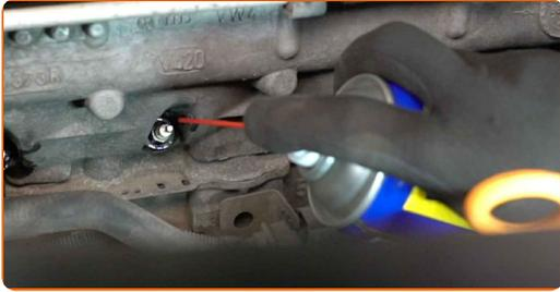
**7** Schrauben Sie die Glühkerzen aus. Verwenden Sie die Zündkerzennuss # 10. Verwenden Sie einen Drehmomentschlüssel.
