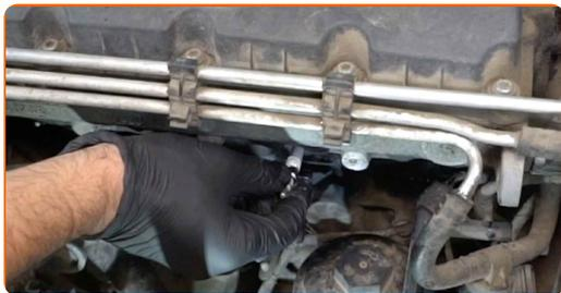
**11** Schrauben Sie die Glühkerzen fest. Verwenden Sie die Zündkerzennuss # 10. Verwenden Sie einen Drehmomentschlüssel. Ziehen Sie ihn mit 15 Nm Drehmoment fest.
