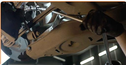
**13** Entfernen Sie die Sattelhalterung.
