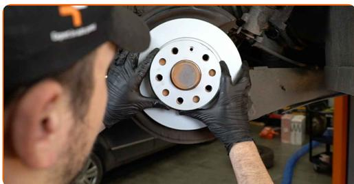
**28** Ziehen Sie die Befestigung der Bremsscheibe fest. Verwenden Sie den Torx T30. Verwenden Sie einen Drehmomentschlüssel. Ziehen Sie ihn mit 4 Nm Drehmoment fest.
