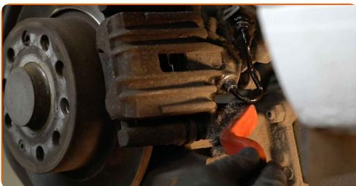
**7** Schrauben Sie die Befestigung des Bremssattels ab. Verwenden Sie Ring-Gabelschlüssel Nr. 13. Verwenden Sie Ring-Gabelschlüssel Nr. 15.
