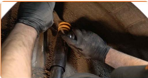
**33** Ziehen Sie den unteren Befestiger des Stoßdämpfers an. Verwenden Sie Stecknuss Nr. 18. Verwenden Sie einen Drehmomentschlüssel. Ziehen Sie ihn mit 120 Nm Drehmoment fest.
