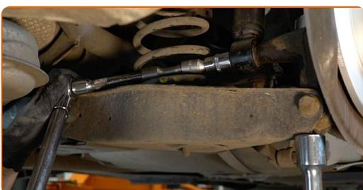
**34** Entfernen Sie den Träger unter dem Arm.
