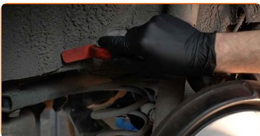
**7** Schrauben Sie die Verbindungselemente der Radkastenabdeckung ab. Verwenden Sie den Torx T27.
