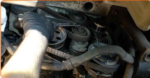
**3** Entfernen Sie den Keilrippenriemen.
