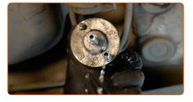
Trennen Sie die Kraftstoffversorgungsleitungen vom Kraftstofffilter.
