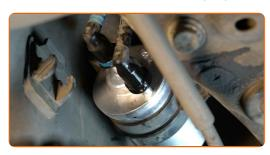
Den Flüssigkeitsbehälter unter dem Kraftstofffilter entfernen.
