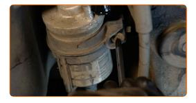
Entfernen Sie den Kraftstofffilter. 8
