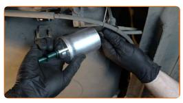
Installieren Sie einen neuen Kraftstofffilter.
