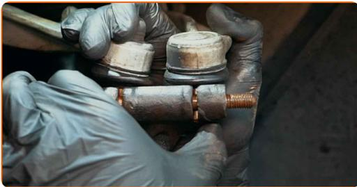
**36** Ziehen Sie die Befestigung des oberen Arms an. Verwenden Sie Ring-Gabelschlüssel Nr. 16. Verwenden Sie Stecknuss Nr. 16. Verwenden Sie einen Drehmomentschlüssel. Ziehen Sie ihn mit 40 Nm Drehmoment fest.
