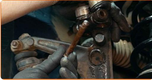
**18** Entfernen Sie die Querlenker.
