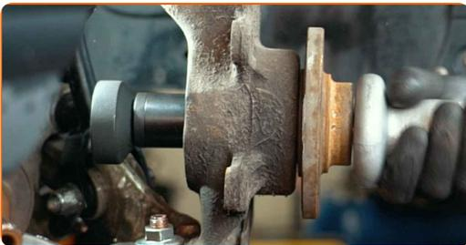
**24** Reinigen Sie den Einbauort für die Nabenlagerung. Benutzen Sie eine Drahtbürste. Benutzen Sie WD-40-Spray.
