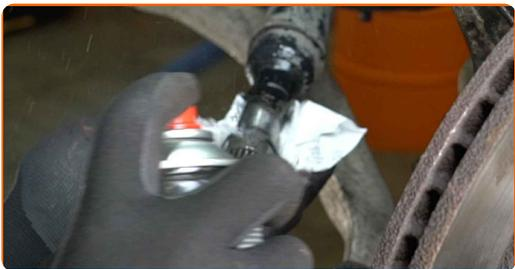
**31** Entfernen Sie den Sicherungsring vom Gleichlaufgelenk. Verwenden Sie einen flachen Schraubendreher.
