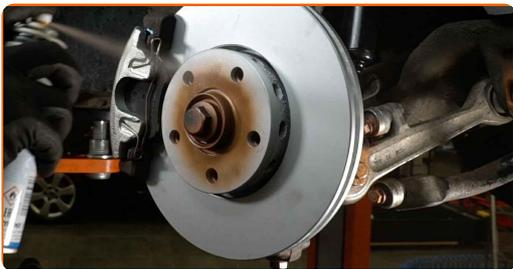
**58** Die Bremsscheibenoberfläche reinigen. Benutzen Sie einen Bremsenreiniger.
