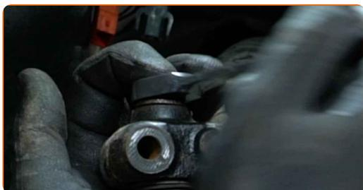
**15** Entfernen Sie die Befestigungsschraube. Verwenden Sie einen Splintentreiber. Benutzen Sie einen Hammer.
