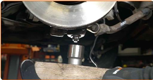
**19** Entfernen Sie die Querlenker. Benutzen Sie ein Brecheisen.
