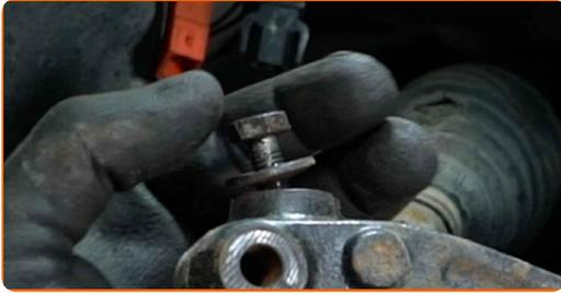
**16** Lockern Sie die Befestigungsschraube des Spurstangenkopfs. Verwenden Sie Ring-Gabelschlüssel Nr. 13.
