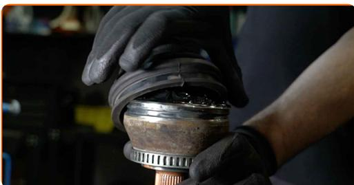
**30** Reinigen Sie den Montagesitz des Gleichlaufgelenks. Verwenden Sie Allzweckreinigungsspray.
