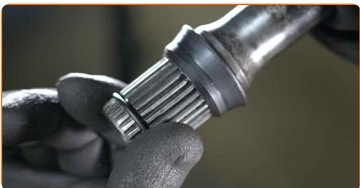
**34** Füllen Sie das Gleichlaufgelenk mit dem im Set enthaltenen Schmierfett.
