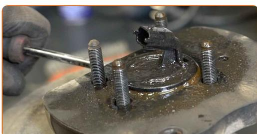
**25** Reinigen Sie den Einbauort für die Nabenlagerung. Benutzen Sie eine Drahtbürste. Benutzen Sie WD-40-Spray.
