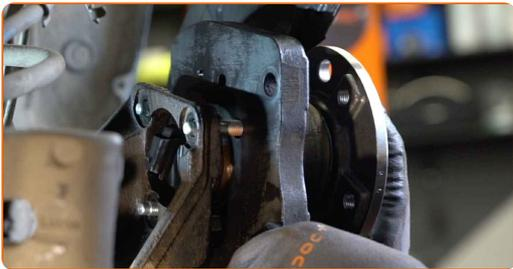
**29** Ziehen Sie das Befestigungselement des Radnabenlagers an. Verwenden Sie Stecknuss Nr. 16. Verwenden Sie einen Drehmomentschlüssel. Ziehen Sie ihn mit 50 Nm Drehmoment fest.+45°
