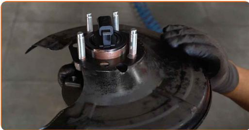
**28** Bauen Sie das Nabenlager gemeinsam mit dem Schutzblech der Bremsscheibe ein.
