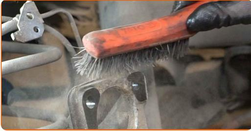
**26** Behandeln Sie das Radnabenlager. Benutzen Sie ein Kupferschmiermittel.
