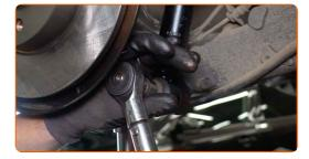
Die Montage unter dem Hinterachsträger entfernen.
