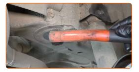
Ziehen Sie die Hinterradaufhängung herunter. Benutzen Sie ein Brecheisen.
