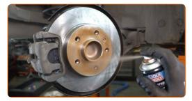
Die Bremsscheibenoberfläche reinigen. Benutzen Sie einen Bremsenreiniger.
