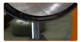
Ziehen Sie den unteren Befestiger des Stoßdämpfers an. Verwenden Sie Stecknuss Nr. E20. Verwenden Sie einen Drehmomentschlüssel. Ziehen Sie ihn mit 130 Nm Drehmoment fest.
