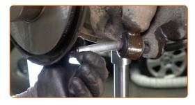
Die Montage unter dem Hinterachsträger entfernen.
