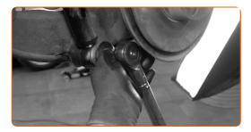
Die Montage unter dem Hinterachsträger entfernen.
