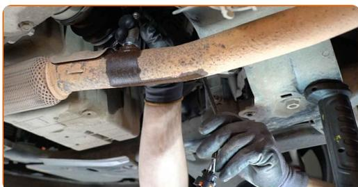
**11** Ziehen Sie die Befestigung der Lambdasonde fest. Verwenden Sie Ring-Gabelschlüssel Nr. 22. Verwenden Sie einen Drehmomentschlüssel. Ziehen Sie ihn mit 32 Nm Drehmoment fest.
