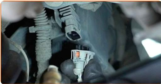
**6** Lösen Sie die Befestigung der Lambdasonde. Verwenden Sie Ring-Gabelschlüssel Nr. 22.
