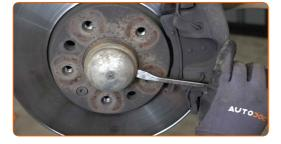
Lösen und entfernen Sie die Nabenmutter. Verwenden Sie Stecknuss Nr. 32. Verwenden Sie ein Windeisen.
