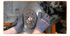
Ziehen Sie die Befestigung der Bremsscheibe fest. Verwenden Sie den Torx T30. Verwenden Sie einen Drehmomentschlüssel. Ziehen Sie ihn mit 7 Nm Drehmoment fest.
