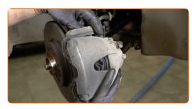
Befestigen Sie die Bremssattelhalterung. Verwenden Sie Stecknuss Nr. 18. Verwenden Sie einen Drehmomentschlüssel. Ziehen Sie ihn mit 100 Nm Drehmoment fest.
