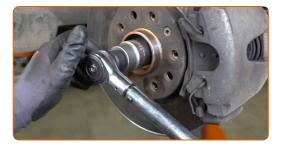
Installieren Sie die Kappe der Nabenmutter.
