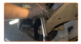
Ziehen Sie die Radnabenmutter fest. Verwenden Sie Stecknuss Nr. 32. Verwenden Sie einen Drehmomentschlüssel. Ziehen Sie ihn mit 250 Nm Drehmoment fest.
