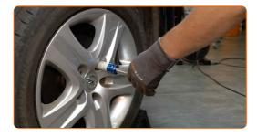
Entfernen Sie den Wagenheber sowie die Unterlegkeile.
