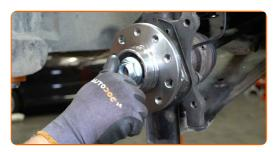
Tragen Sie etwas Kupferschmiermittel an der Stelle auf, an welcher die Nabe Kontakt zur Bremsscheibe hat.
