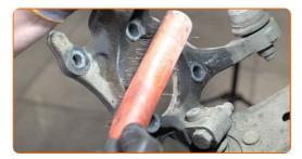
Behandeln Sie das Radnabenlager. Benutzen Sie ein Kupferschmiermittel.
