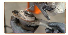
Reinigen Sie den Einbauort für die Nabenlagerung. Benutzen Sie eine Drahtbürste. Benutzen Sie WD-40-Spray.
