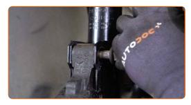
Ziehen Sie die Nabe hindurch. Verwenden Sie Stecknuss Nr. E18. Verwenden Sie einen Drehmomentschlüssel. Ziehen Sie ihn mit 90 Nm Drehmoment fest.+45°
