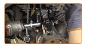
Entfernen Sie die Befestigungsschrauben.
