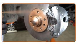
Die Bremsscheibenoberfläche reinigen. Benutzen Sie einen Bremsenreiniger.
