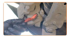
Lösen Sie die Befestigung der Sattelhalterung. Verwenden Sie Stecknuss Nr. 18. Verwenden Sie ein Windeisen.
