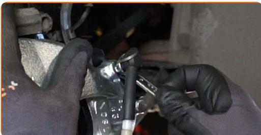
**31** Trennen Sie den Schlauch des Bremsentlüftungs-Kits.
