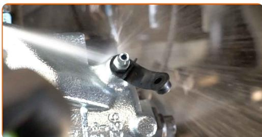
**Austausch: Bremssattel – Opel Astra H Limousine. Tipp von AUTODOC:**
