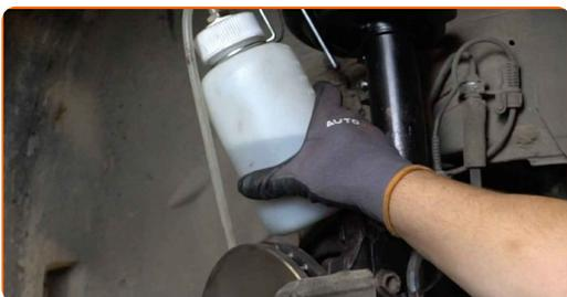
**32** Ziehen Sie die Entlüftungsschraube des Bremssattels an. Verwenden Sie Ring-Gabelschlüssel Nr. 9. Verwenden Sie einen Drehmomentschlüssel. Ziehen Sie ihn mit 5 Nm Drehmoment fest.
