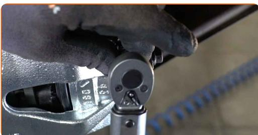
**33** Entfernen Sie den Schmutz von der Schraube zur Befestigung des Bremsschlauchs. Benutzen Sie einen Bremsenreiniger.
