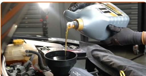
Austausch: Motoröl und Ölfilter – Opel Astra H Limousine. AUTODOC-Experten empfehlen:
