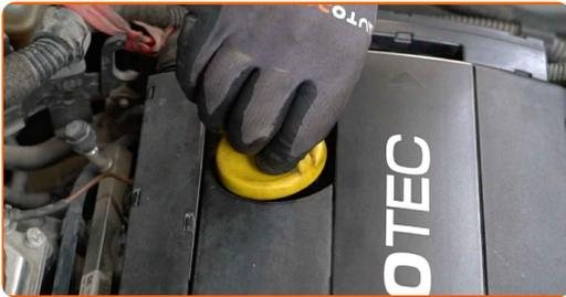
**31** Befestigen Sie den Deckel des Öleinfüllstutzens.
