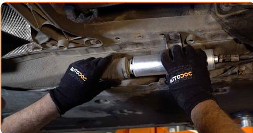
**22** Den Flüssigkeitsbehälter unter dem Kraftstofffilter entfernen.
