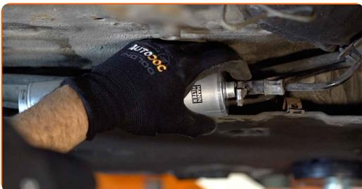
**17** Ziehen Sie die Befestigung der Kraftstoffzuleitung an. Verwenden Sie einen flachen Schraubendreher.
