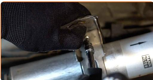
**20** Ziehen Sie die Befestigungsmittel des Treibstofffilters fest. Verwenden Sie Stecknuss Nr. 13. Verwenden Sie einen Ratschenschlüssel.
