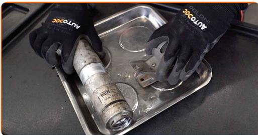
**15** Installieren Sie einen neuen Kraftstofffilter.
