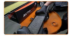
Entfernen Sie das Filterelement aus dem Filtergehäuse.
