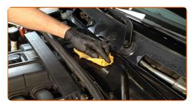
Installieren Sie den Gehäusedeckel des Innenraumfilters. Stellen Sie sicher, dass Sie dabei das Klicken hören, welches entsteht, wenn sich diese in der korrekten Position befindet.
