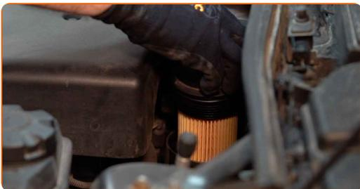
**29** Schrauben Sie die Kappe an. Verwenden Sie Stecknuss Nr. 36. Verwenden Sie einen Drehmomentschlüssel. Ziehen Sie ihn mit 25 Nm Drehmoment fest.
