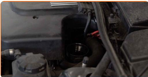
**27** Schmieren Sie die Gummidichtung des neuen Filters mit einer kleinen Menge frischen Öls.
