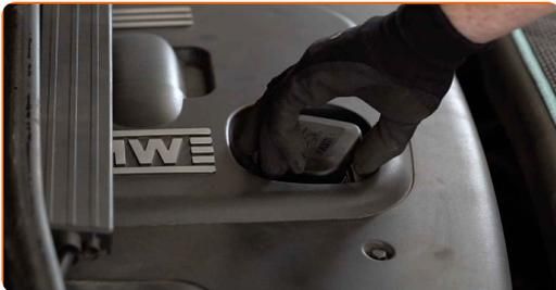
**4** Schrauben Sie den Filtergehäusedeckel zusammen mit dem alten Filterelement ab. Verwenden Sie Stecknuss Nr. 36. Verwenden Sie einen Ratschenschlüssel.
