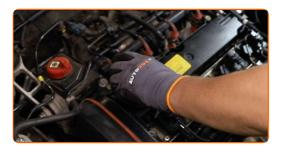
Installieren Sie die Motorabdeckung und sichern Sie diese.
