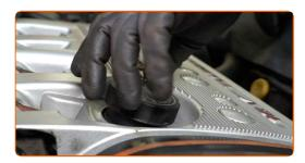
Entfernen Sie die Öleinfüllschraube.
