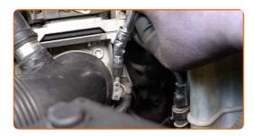
Trennen Sie das Luftansaugrohr vom Luftfilter-Gehäuse.
