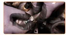
Sichern Sie die Klemme des Kühlmittelschlauchs. Verwenden Sie eine Clic-R-Kragenzange.
