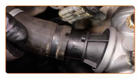
Sichern Sie die Klemme des Kühlmittelschlauchs. Verwenden Sie Stecknuss Nr. 7. Verwenden Sie einen Ratschenschlüssel.
