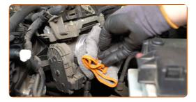
25 Entfernen Sie das Filterelement aus dem Filtergehäuse.
