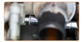
Entfernen Sie das Thermostatgehäuse zusammen mit dem Thermostat. Benutzen Sie ein Brecheisen.
