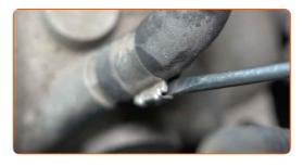
Lösen Sie den Kühlmittelschlauch.
