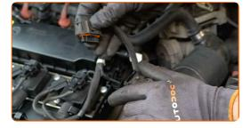
Ziehen Sie den Stecker des Luftmassenmessers ab. Verwenden Sie einen flachen Schraubendreher.
