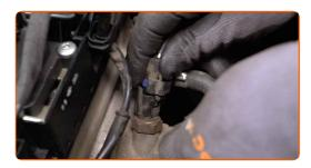
Lockern Sie die Klemme des Kühlmittelschlauchs. Verwenden Sie einen flachen Schraubendreher.
