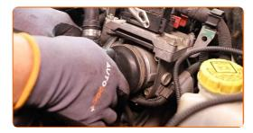
Ziehen Sie die Halteklammer und Befestigungen am Ansaugrohr des Luftfilters fest. Verwenden Sie Stecknuss Nr. 7. Verwenden Sie einen Ratschenschlüssel.
