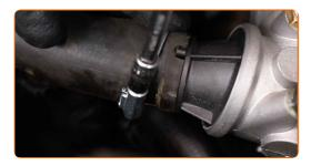
Behandeln Sie den Stecker des Kühlmitteltemperatursensor. Verwenden Sie dielektrisches Fett.
