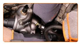
Sichern Sie die Klemme des Kühlmittelschlauchs. Verwenden Sie Stecknuss Nr. 7. Verwenden Sie einen Ratschenschlüssel.
