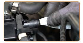
Lösen Sie den Steckverbinder des Luftmassenmessers.
