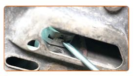
Lösen Sie den Kühlmittelschlauch.
