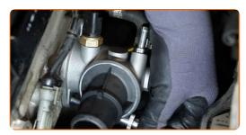
Schrauben Sie die Befestigungselemente des Thermostatgehäuses fest. Verwenden Sie Stecknuss Nr. 13. Verwenden Sie einen Drehmomentschlüssel. Ziehen Sie ihn mit 11 Nm Drehmoment fest.
