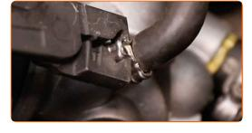
Bringen Sie den Kühlmittelschlauch an.
