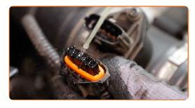
Bringen Sie den Steckverbinder des Luftmassenmessers an.
