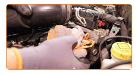
Verbinden Sie das Luftansaugrohr mit dem Luftfilter-Gehäuse.
