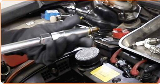
**15** Tragen Sie eine dünne Schicht eines speziellen Hochtemperatur-Anti-Seize-Schmiermittels auf das Gewinde der neuen Zündkerzen auf.
