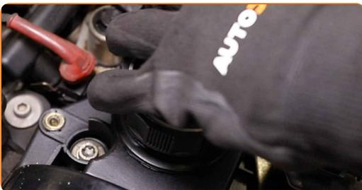
**9** Lösen Sie die Steckverbindung von den Zündspulen.
