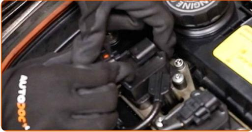
**10** Schrauben Sie die Zündspulenklammer ab. Verwenden Sie den Torx T40. Verwenden Sie einen Ratschenschlüssel.
