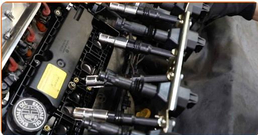
**12** Entfernen Sie Schmutz, Staub und Ablagerungen von den Zündkerzenbohrung.
