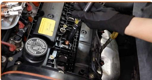
**17** Schrauben Sie die neuen Zündkerzen an und ziehen Sie diese fest. Verwenden Sie die Zündkerzennuss # 16. Verwenden Sie einen Drehmomentschlüssel. Ziehen Sie ihn mit 24 Nm Drehmoment fest.
