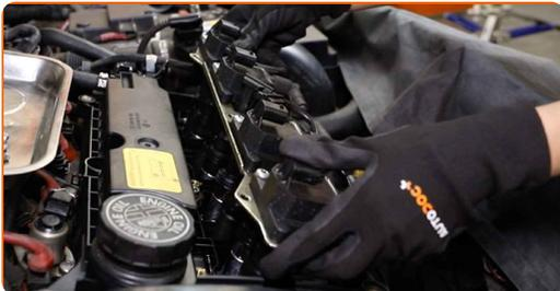
**19** Ziehen Sie die Zündspulen Befestigung an. Verwenden Sie den Torx T40. Verwenden Sie einen Drehmomentschlüssel. Ziehen Sie ihn mit 7 Nm Drehmoment fest.
