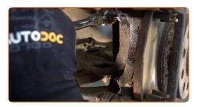
13 Entfernen Sie die Sattelhalterung.
