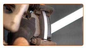
Installieren Sie den Bremssattel und fixieren Sie diesen. Verwenden Sie Ring-Gabelschlüssel Nr. 13. Verwenden Sie Ring-Gabelschlüssel Nr. 15. Verwenden Sie Stecknuss Nr. 13. Verwenden Sie einen Drehmomentschlüssel. Ziehen Sie ihn mit 35 Nm Drehmoment fest.
