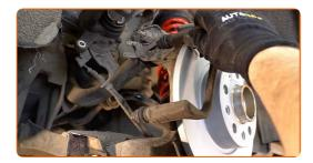
Befestigen Sie die Bremssattelhalterung. Verwenden Sie Stecknuss Nr. E12. Verwenden Sie einen Drehmomentschlüssel. Ziehen Sie ihn mit 60 Nm Drehmoment fest.
