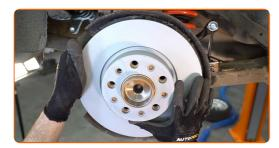
Ziehen Sie die Befestigung der Bremsscheibe fest. Verwenden Sie Inbusschlüssel Nr. H5. Verwenden Sie einen Drehmomentschlüssel. Ziehen Sie ihn mit 7 Nm Drehmoment fest.
