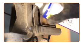
Lösen Sie die Befestigung der Sattelhalterung. Verwenden Sie Stecknuss Nr. E12. Verwenden Sie einen Ratschenschlüssel.
