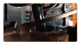
Entfernen Sie die Befestigungsschrauben.
