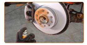
Die Bremsscheibenoberfläche reinigen. Benutzen Sie einen Bremsenreiniger.
