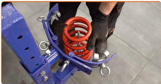
**29** Installieren Sie die Manschette und eine Stoßstopp auf den Stoßdämpfer.
