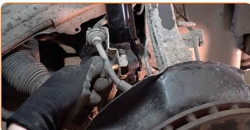
**40** Stützen Sie den Arm. Benutzen Sie einen hydraulischen Getriebeheber.
