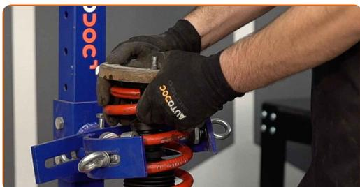
**32** Ziehen Sie die Federbeinkolbenstangenmutter an. Verwenden Sie Ring-Gabelschlüssel Nr. 6. Verwenden Sie Ring-Gabelschlüssel Nr. 18. Verwenden Sie Stecknuss Nr. 18. Verwenden Sie einen Drehmomentschlüssel. Ziehen Sie ihn mit 33 Nm Drehmoment fest.
