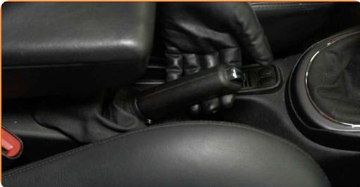
**2** Lockern Sie das Feststellbremsseil. Verwenden Sie Ring-Gabelschlüssel Nr. 13.
