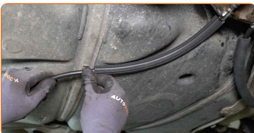
**22** Schrauben Sie die Befestigung des Handbremsseils an. Verwenden Sie Stecknuss Nr. 10. Verwenden Sie einen Drehmomentschlüssel. Ziehen Sie ihn mit 6 Nm Drehmoment fest.
