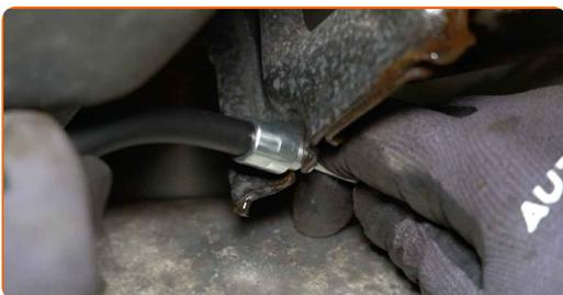
**20** Sichern Sie das Feststellbremskabel mit der Halteklammer. Verwenden Sie eine Wasserpumpenzange.
