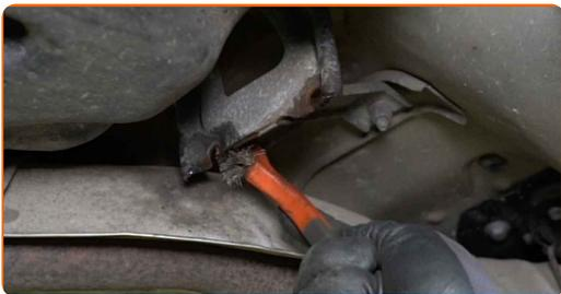
**19** Befestigen Sie das Feststellbremskabel an den Feststellbremsmechanismus.
