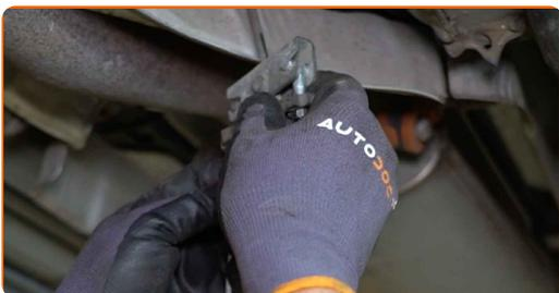
**18** Reinigen Sie die Montagesitze des Handbremsseils. Benutzen Sie eine Drahtbürste. Benutzen Sie WD-40-Spray.
