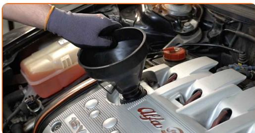
22 Füllen Sie Öl durch den Einfüllstutzen in den Motor. Erforderliche Menge an Öl: 4 l.
