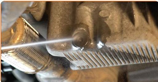
**7** Drehen Sie die Ablassschraube heraus. Verwenden Sie den Torx T50. Verwenden Sie einen Ratschenschlüssel.
