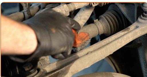
**7** Schrauben Sie die Befestigungsmutter heraus, die die Koppelstange an der Stoßdämpfergabel befestigt. Verwenden Sie Ring-Gabelschlüssel Nr. 16.
