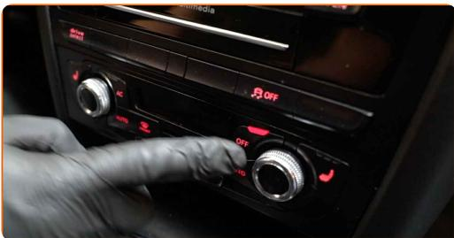
**12** Schalten Sie die Klimaanlage ein. Dies ist notwendig, um sicherzustellen, dass die Komponente ordnungsgemäß funktioniert.
