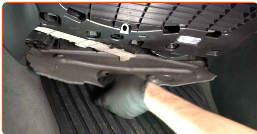
**4** Entfernen Sie den Gehäusedeckel des Innenraumfilters.
