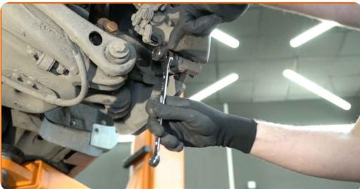
**11** Entfernen Sie den Bremssattel.
