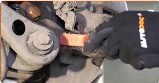
**10** Schrauben Sie die Befestigung des Bremssattels ab. Verwenden Sie Ring-Gabelschlüssel Nr. 13. Verwenden Sie Ring-Gabelschlüssel Nr. 15. Verwenden Sie Stecknuss Nr. 13. Verwenden Sie einen Ratschenschlüssel.
