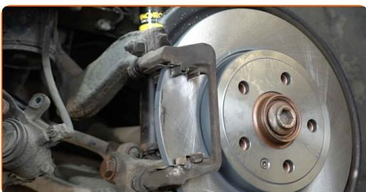
**16** Behandeln Sie die Bremsbeläge in dem Bereich, wo ihre Oberfläche mit dem Bremssattelhalter in Berührung tritt. Benutzen Sie eine Anti-Quietsch-Paste.
