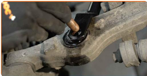
**51** Schrauben Sie die Befestigung ein, die das Federbein mit dem Querlenker verbindet. Verwenden Sie Ring-Gabelschlüssel Nr. 18 (2 Teile).
