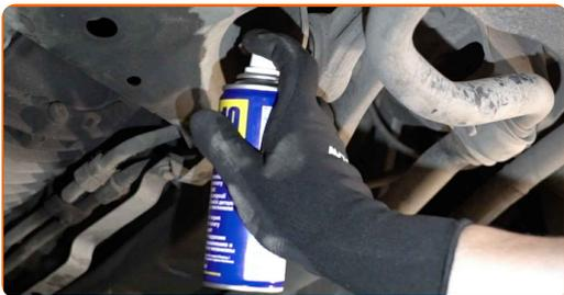
**24** Schrauben Sie das hintere Befestigungselement heraus, das den Querlenker mit dem Hilfsrahmen verbindet. Verwenden Sie Ring-Gabelschlüssel Nr. 18 (2 Teile).
