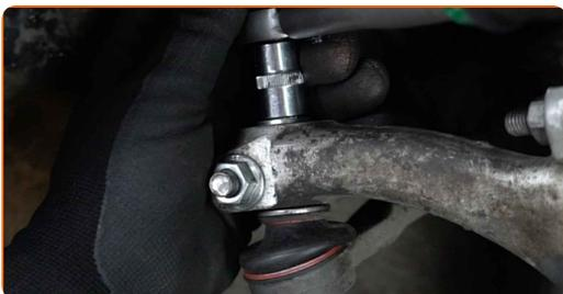
**63** Ziehen Sie die Befestigungsmutter an, die den Spurstangenkopf mit dem Achsschenkel verbindet. Verwenden Sie Stecknuss Nr. 15. Verwenden Sie einen Drehmomentschlüssel. Ziehen Sie ihn mit 45 Nm Drehmoment fest.
