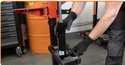
**39** Installieren Sie die Feder am Stoßdämpfer.
