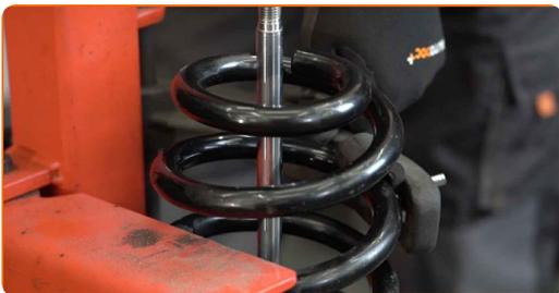
**41** Installieren Sie die Staubschutzmanschette und den Anschlagpuffer auf dem neuen Stoßdämpfer.
