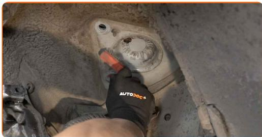
**48** Installieren Sie das Federbein am Radlauf.
