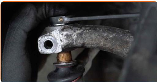
**61** Schrauben Sie die Befestigungsmutter auf, die den Spurstangenkopf mit dem Achsschenkel verbindet. Verwenden Sie Stecknuss Nr. 15. Verwenden Sie einen Ratschenschlüssel.
