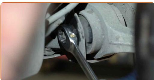
**25** Schrauben Sie die vordere Armbefestigung ab. Verwenden Sie Ring-Gabelschlüssel Nr. 18 (2 Teile).
