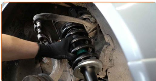
**49** Schrauben Sie die obere Befestigung des Federbeinbefestigung an. Verwenden Sie Stecknuss Nr. 16. Verwenden Sie einen Ratschenschlüssel. Schrauben Sie diese nicht fest.
