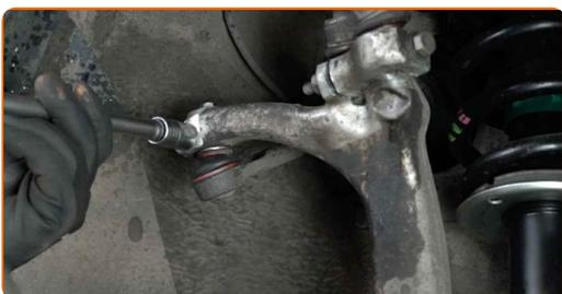
**62** Schrauben Sie die Befestigungsschraube des Spurstangenkopfs fest. Verwenden Sie Stecknuss Nr. 13. Verwenden Sie einen Drehmomentschlüssel. Ziehen Sie ihn mit 7 Nm Drehmoment fest.
