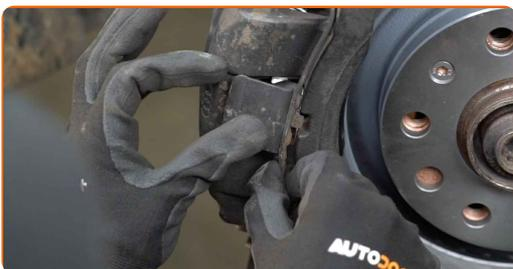
**33** Verbinden Sie den Bremsbelag-Verschleiß-Sensor.
