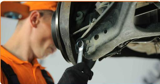
**11** Entfernen Sie die Befestigungsschraube. Verwenden Sie einen Splintentreiber. Benutzen Sie einen Hammer.
