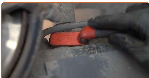
**7** Untere Befestigung der Stoßdämpferfedern abschrauben. Verwenden Sie Ring-Gabelschlüssel Nr. 19. Verwenden Sie Stecknuss Nr. 19. Verwenden Sie einen Ratschenschlüssel.
