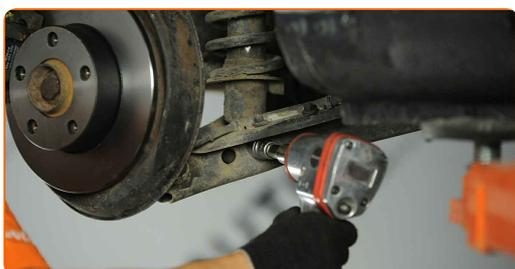
**8** Entfernen Sie die Befestigungsschraube.
