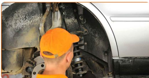
**41.1** Ziehen Sie die oberen Befestigungen des Federbeins an.
