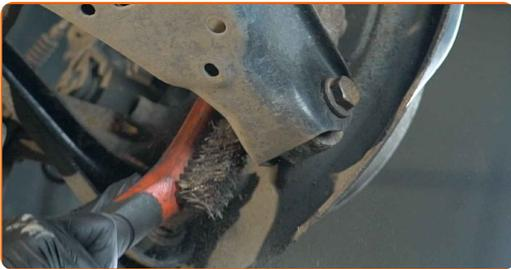
**10** Drehen Sie Befestigungselement auf, das den Querlenker mit dem hinteren Achsschenkel verbindet. Verwenden Sie Ring-Gabelschlüssel Nr. 19. Verwenden Sie Stecknuss Nr. 19. Verwenden Sie einen Ratschenschlüssel.
