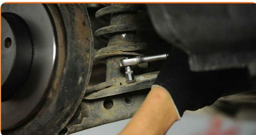
**13** Entfernen Sie die Halterung des ABS-Kabelbaums.
