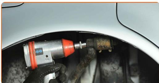
**16** Entfernen Sie die Befestigungsschraube.
