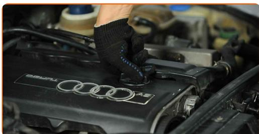
**18** Entfernen Sie die Öleinfüllschraube.
