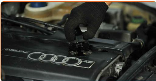
**23** Befestigen Sie den Deckel des Öleinfüllstutzens.
