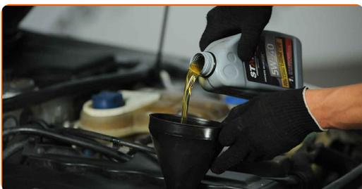
**Austausch: Motoröl und Ölfilter – Audi A4 B5 Avant. Tipp von AUTODOC:**
