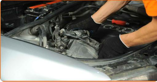
**13** Klicken Sie die Clips der Luftfilterabdeckung ein. Verwenden Sie einen flachen Schraubendreher.
