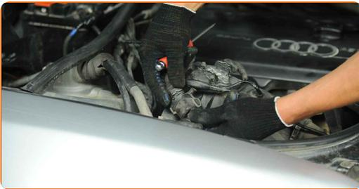
**16** Ziehen Sie die Klemme am Luftansaugschlauch fest. Verwenden Sie einen flachen Schraubendreher.
