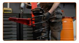
Entfernen Sie das zusammengebaute Federbein.
