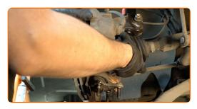
Verbinden Sie das Kugelgelenk mit dem Lenker.
