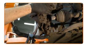
Lösen Sie das untere Befestigungselement, dass das Federbein mit dem Achsschenkel verbindet. Verwenden Sie eine spezielle Schraubnuss, um den Stoßdämpfer zu entfernen. Verwenden Sie einen Ratschenschlüssel.
