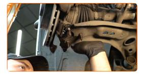
Schrauben Sie die Befestigungen des Kugelgelenks ein. Verwenden Sie Stecknuss Nr. 16. Verwenden Sie einen Ratschenschlüssel.
