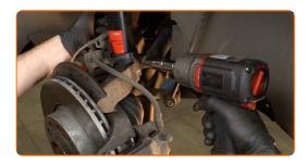
Montieren Sie den Querlenker.
