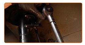
Ziehen Sie das Kugelgelenk an. Verwenden Sie Stecknuss Nr. 16. Verwenden Sie einen Drehmomentschlüssel. Ziehen Sie ihn mit 60 Nm Drehmoment fest.
