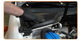
74 Bauen Sie die Dichtung der Windabweiserabdeckung ein.
