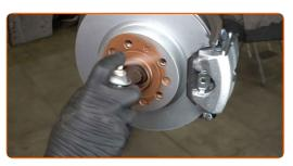
Die Bremsscheibenoberfläche reinigen. Benutzen Sie einen Bremsenreiniger.
