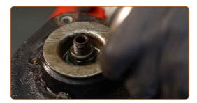
Entfernen Sie die Stangenmutter des Federkolben. Verwenden Sie Inbusschlüssel Nr. H7. Verwenden Sie Stecknuss Nr. 21. Verwenden Sie einen Ratschenschlüssel.
