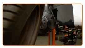
Reinigen Sie die Befestigungen der Koppelstange. Benutzen Sie eine Drahtbürste. Benutzen Sie WD-40-Spray.
