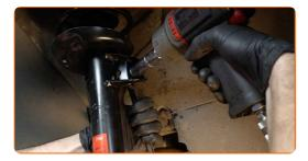
Ziehen Sie die unteren Befestigungen an, die das Federbein mit dem Achsschenkel verbinden. Verwenden Sie Stecknuss Nr. 18. Verwenden Sie einen Drehmomentschlüssel. Ziehen Sie ihn mit 70 Nm Drehmoment fest.+90°
