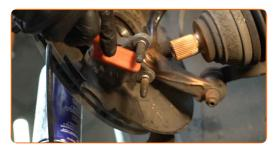
52 Entfernen Sie den Träger unter dem Achsschenkel.
