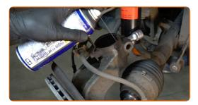
Befestigen Sie das Dämpferbein auf dem Achsschenkel.
