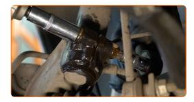
Entfernen Sie die Befestigungsschraube.
