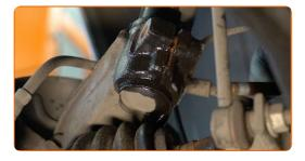
Lösen Sie das Befestigungselement, welches die Antriebswelle mit der Radnabe verbindet. Verwenden Sie Stecknuss Nr. 24. Verwenden Sie einen Ratschenschlüssel.
