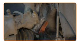
Schrauben Sie das untere Befestigungselement ab, dass das Federbein mit dem Achsschenkel verbindet.
