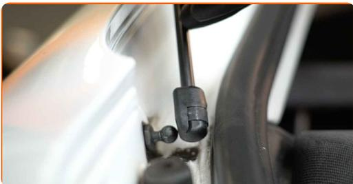
**Austausch: Heckklappendämpfer – Audi A3 8PA. Fachleute empfehlen:**
