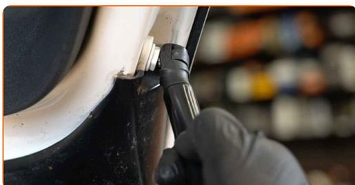
**13** Bringen Sie die neue Gasfeder des Kofferraumdeckels an.
