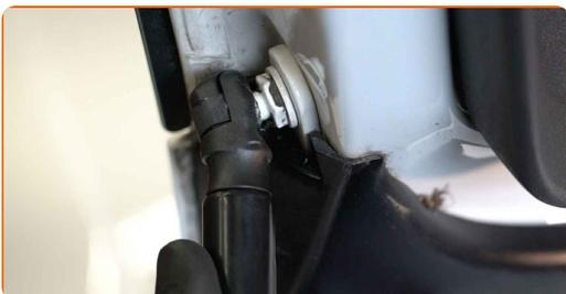
**16** Entfernen Sie den hydraulischen Getriebeheber.
