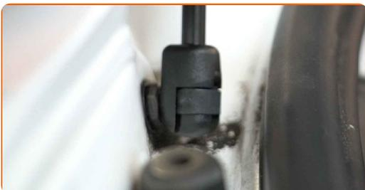
**15** Lassen Sie den Sprengring, der die Gasfeder mit dem Kofferraumdeckel verbindet, einrasten.
